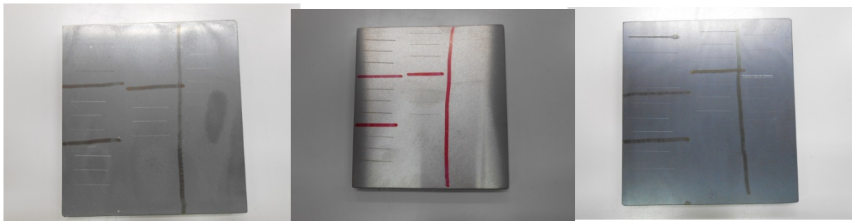
図 3 作製した吸収体の写真。(a) 酸化クロム、(b) タングステンカーバイド、(c) チタニア及びアルミナの混合溶射膜。
